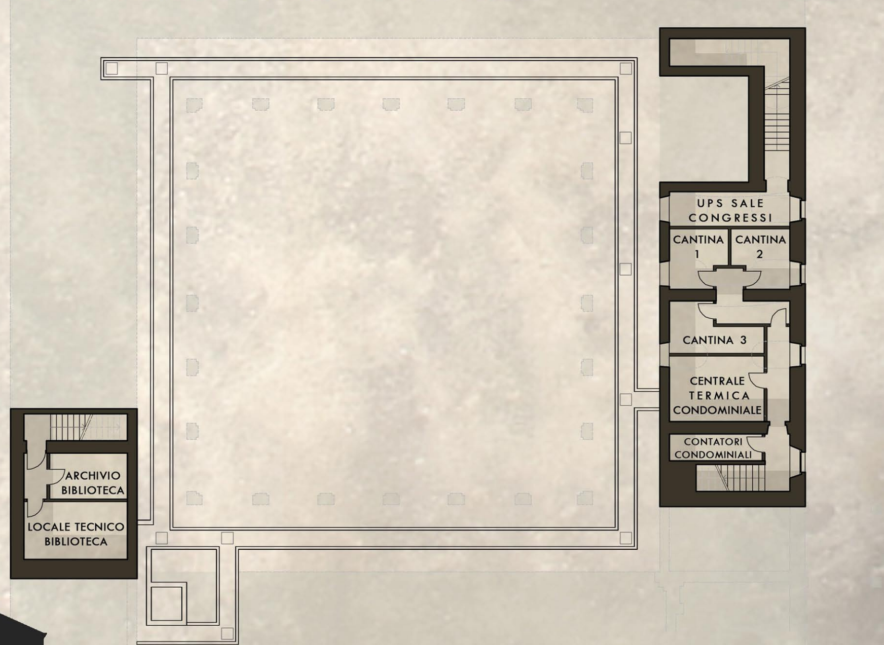
PIANTA PIANO INTERRATO SCALA 1:200
